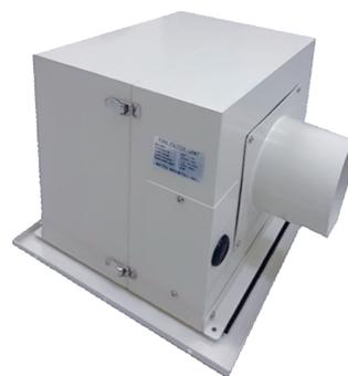
外気取込み用のHEPAフィルタ付きファンユニットです。外気ダクトに接続（天井裏に設置）し、HEPAフィルタを通して室内にクリーンエアを供給し、室内を陽圧にします。
